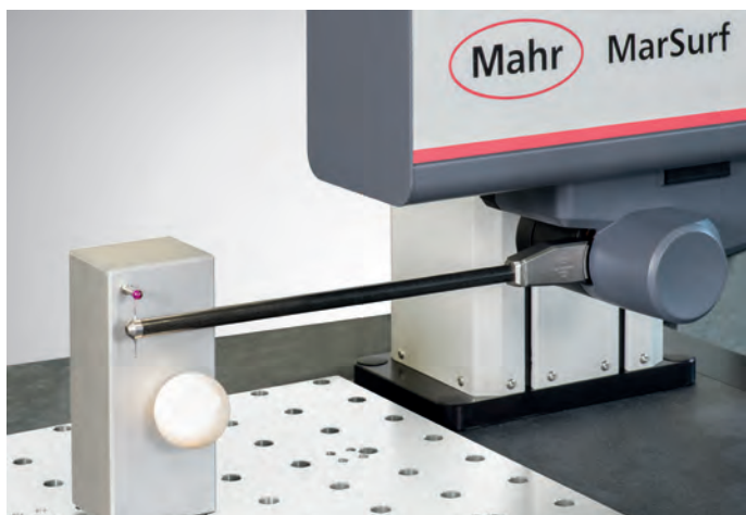
Pomiar ramieniem z końcówką o podwójnym ostrzu pomiarowym na wzorcu kalibracyjnym.
