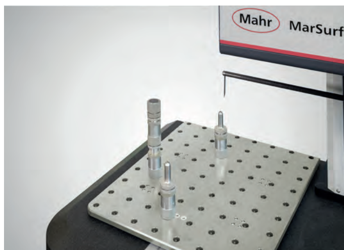
Płyta bazowa z podparciami nastawnymi zawierającymi uchwyt kłowy i magnetyczny.
