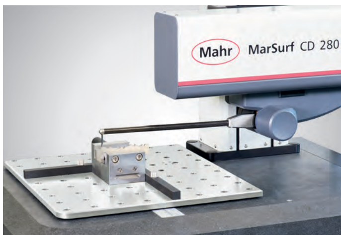
Pomiar standardowym ramieniem pomiarowym CPG A 36-350-25/12° na części szkoleniowej.
