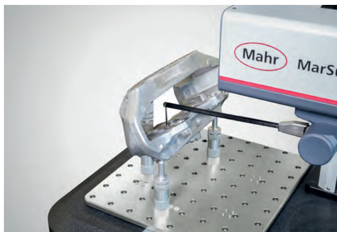
Pomiar ramieniem z długim ostrzem pomiarowym CPG A 62-350-25/19° umożliwia dostęp do głębiej położonych punktów pomiarowych.
